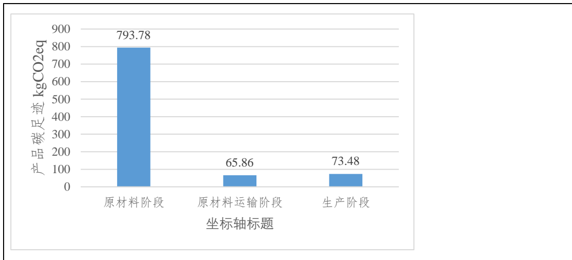
图 4-1 1 架液压支架各阶段碳排放分布图
